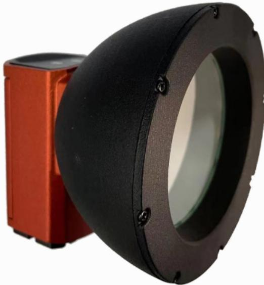
生产流水线条码读码器选择的时候需要考虑以下因素:1、要考虑条码的类型和条码的宽度,如条码的码制、位数以及密度大小。2、要考虑条码粘贴的方向和位置,和扫描光线平行还是垂直?3、要考虑流水线的速度。4、要考虑扫描距离,条码和读码器之间的距离要求。5、要考虑传送带的振动情况。6、要考虑支架的安装,是否需要可调整的支架。7、要考虑传感器以及报警装置。8、要考虑需要什么接口?是否需要组成网络接入同一个服务器或者PLC[9]要考虑和后台应用系统的接口。
