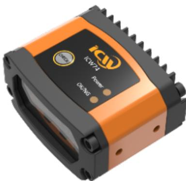
手持式与固定式工业二维码读码器的比较：手持式二维码读码器应用于许多领域，这类条码读取器特别适用于条码尺寸多样、识读场合复杂、条码形状不规整的应用场合。固定式二-维码读码器扫描时不需用人手把持，适用于省力、人手劳动强度大(如很市的扫描结算台)或无人操作的自动识别应用。在工业自动化领域，持拭工业维码读码器需人I近距离对准条码进行识读，粗速度慢、自动化程度低，这些缺点使其无法满足工业企业生产的需求。而固定式工业二维码读码器不需要人工操作，贴有条码的产品或者零部件经过读码器的有效扫描区域时，就能够自动读取条码中的信息。对于工业传送带上的物品，可以做到基本上不需要人干预的全自动扫描；对于手工搬运
